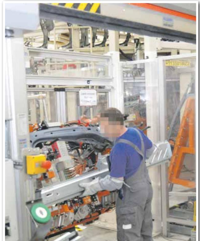
**B-Säulen-Anlage Karosseriebau Golf wird ergonomischer:** In der B-Säulen-Anlage in Halle 2a bewegen die Beschäftigten pro Schicht 1,8 Tonnen Stahl per Hand. 360 Bauteile aus dem Behälter nehmen, drehen und in die Anlage legen. „Wir ändern im WU die Aufnahmevorrichtung in der Maschine. Dann müssen die Einleger das Werkstück nicht mehr drehen. Das senkt die Belastung im Arbeitsgang“, sagt Planer Lars Kascha, der das Projekt umsetzt.
