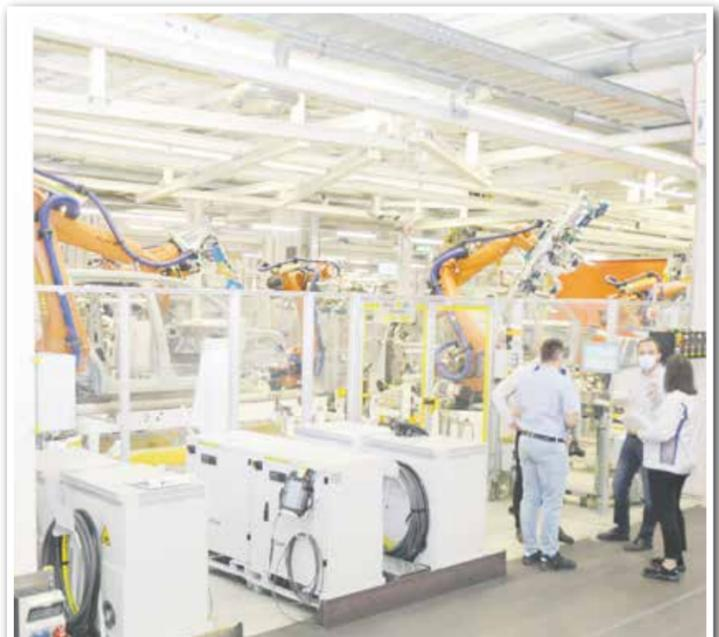
**Automatischer Einbau für Tiguan, Touran und Tarraco:** In Halle 3 wird der Einbau von Heckklappe und Türen in die Karosserie automatisiert. Völlig neu ist die computergesteuerte Ausrichtung beim Einbau: Fühler vermessen vorher Anbauteil und Karosserie und berechnen dann die optimale Einbaulage. „Damit bauen die Roboter Klappen und Tür bestmöglich ein“, sagt der zuständige Planer Sascha Kuhn.
