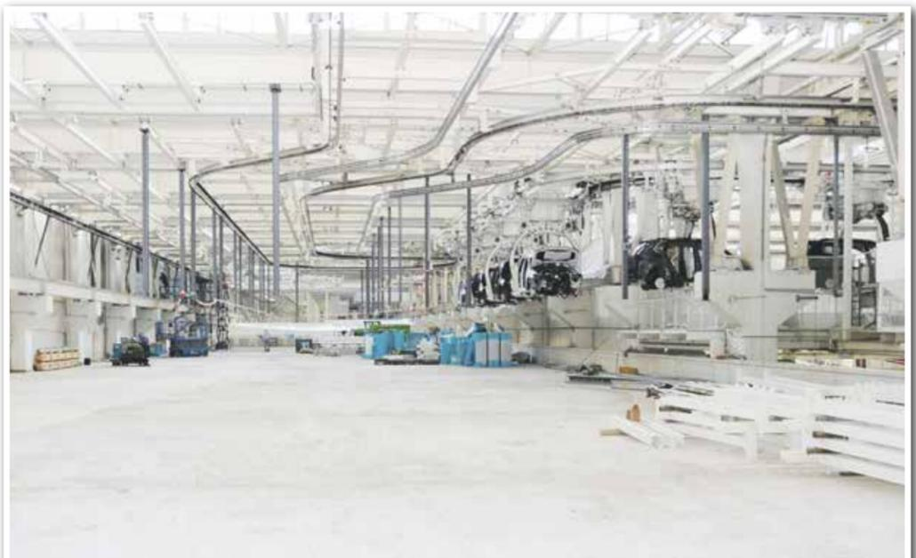
**Neue Decke eingezogen:** In Halle 8 wurde das so genannte Tieffeld überbaut. Auf der neu geschaffenen Fläche entstehen zwölf zusätzliche Arbeitstakte für die Montagelinie 4. Damit ist nun genug Platz da, um den Plug-In-Hybrid zu integrieren. Nach den baulichen Maßnahmen erfolgt auch die neue fördertechnische Anbindung und Einrichtung der Arbeitstakte.
